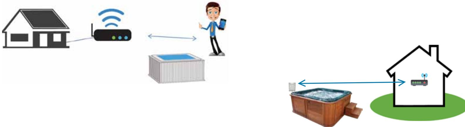
你也可以尝试把无线模块移动到院子中其它无线网络能覆盖的地方。或者将无线模块挂在浴缸的外面，这样就不需要将无线模块安装在浴缸边缘下方。
