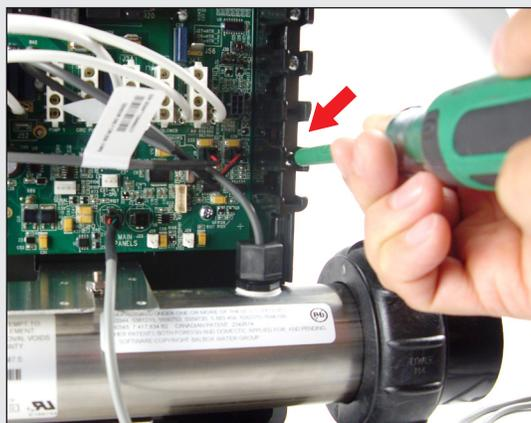
– Remueva 1 tornillo para abrir el sujetador del alambre/cable.
