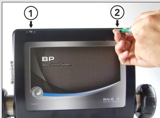
– Utilice un desarmador phillips para remover los 2 tornillos superiores que sujetan la cubierta del sistema en su lugar.
