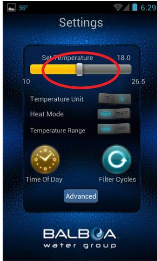
La pantalla de configuraciones le permite seleccionar la temperatura de su spa, y cambiar la temperatura de F° a C°, elegir el tiempo del día, ciclos de filtración y mas.
