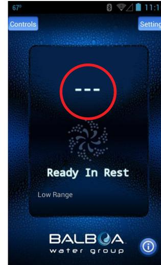
Esto es normal si los motores no han sido encendidos en un tiempo – la temperatura del agua es desconocida.
