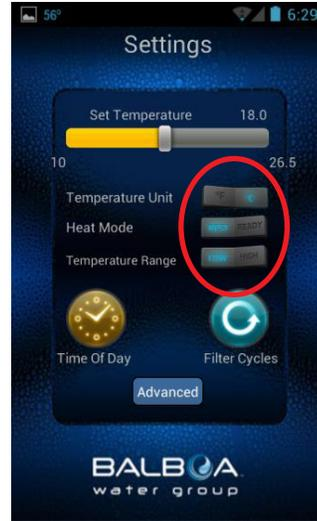
Presione los botones para cambiar la temperatura de F° a C°, modo de calefacción – Listo y Descansar y el Rango de Temperatura – Alta & Baja.
