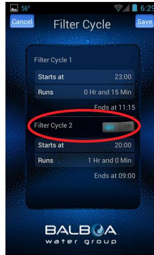
Presioné (Android™) o Deslice (iOS®) el botón para encender / apagar el Ciclo de Filtración.
