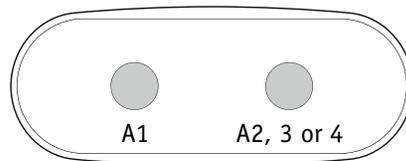
**El Panel Auxiliar AX20 conectado al Banco 1 controlará A1 + A2, A3 o A4.**
