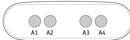
**El Panel Auxiliar AX40 conectado al Banco 1 controlará A1 + A2, A3 y A4.**
